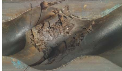
Nachbau: Ausfall nach kurzem Betrieb durch Ablösung von Statorteilen
