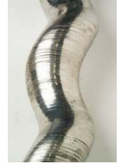
Nachbau: Rotor aus unbekanntem Metall mit starker Abnutzung und schlechtem Wirkungsgrad
